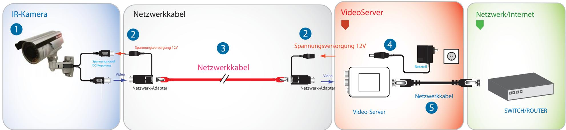
Maximale Reichweite bei CAT5-Verkabelung: 100m
