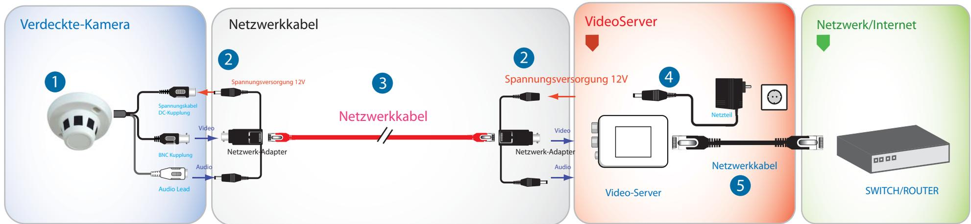
Maximale Reichweite bei CAT5-Verkabelung: 100m
